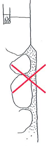
Interdit : Enduit en surépaisseur détournant les pierres d'encadrement ou les pierres d'angles
