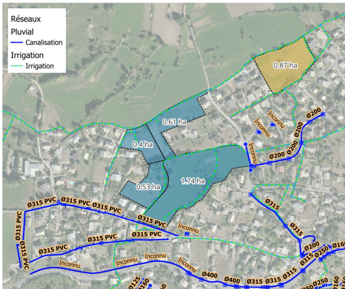
Illustration 7 : Identification des réseaux d'irrigation et des réseaux pluviaux sur la zone d'étude des OAP
