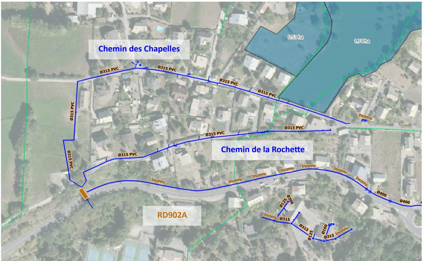
Illustration 9 : Identification des réseaux pluviaux au niveaux de l'aval de l'OAP n°2 du Champ de l'Aze avec le rejet au niveau de la RD902A
